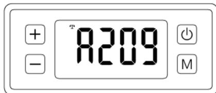
这时你要手动将水平仪原地旋转180°（尽量保证回归原位），当倒计时结束，水平仪自动完成A2的数据采集。
